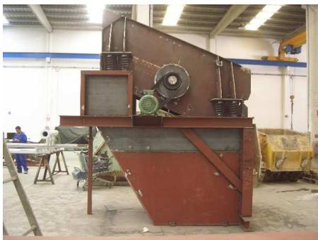
Los **Precribadores Dinámicos, Serie PCD**, están diseñados para realizar un primer corte del material en la fase primaria. Su función es separar el material mas fino que no es apto (estériles), o que no precisa trituración primaria.
