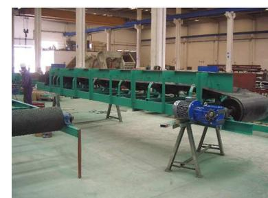
Disponemos de una amplia gama de **Cintas Transportadoras**, entre las que destacan las de la gama **CL** y la gama **JR**, las cintas **giratorias**, y las cintas con **tripper** de descarga para acopio de materiales a granel.
