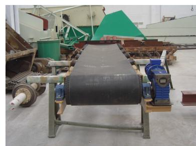
Los **Alimentadores de Banda** son máquinas que generalmente se colocan bajo tolva. Su misión es proporcionar una alimentación homogénea de los materiales. Especialmente están indicados para la alimentación de arenas, gravas y materiales arcillosos.
